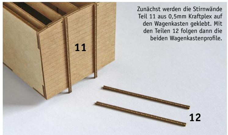
Zunächst werden die Stirnwände Teil 11 aus 0,5mm Kraftplex auf den Wagenkasten geklebt. Mit den Teilen 12 folgen dann die beiden Wagenkastenprofile.
