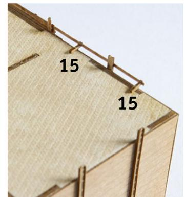
Für die Laufschienehalter Teil 15 sind bereits entsprechende Löcher vorgesehen. Die Laufschiene sollten mit etwas Sekundenkleber stabilisiert werden.
