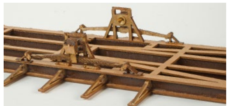
Die fertig montierten Achshalter mit eingesetzten Achslagern
