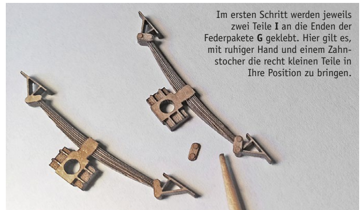
Zur besseren Übersicht alle Teile der Achslager in der Übersicht. Mit der nötigen Ruhe lassen sich die Baugruppen problemlos zusammensetzen (Fotos zeigen diese Montageschritte am Beispiel des Universal-Fahrgestells).
