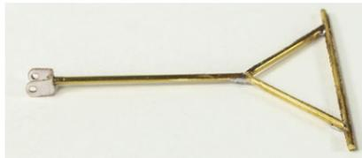
Sollte etwas Kleber auf den Untergrund getropft sein, erweist sich jetzt der Stahlklotz als nützlich: Mit Hilfe eines Skalpell oder spitzen Cutters kann das Bremsdreieck samt Beschlag vom Untergrund gelöst werden.
