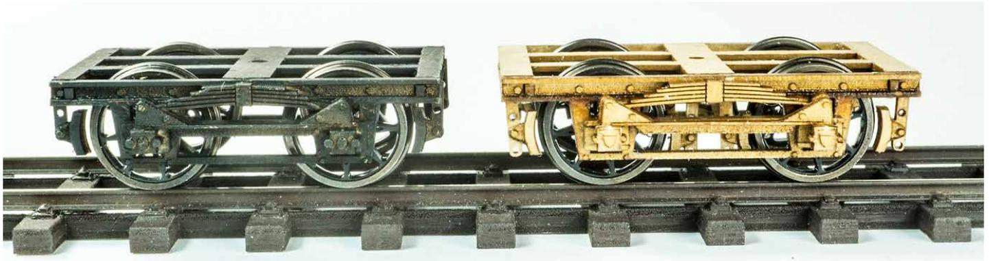
Oben: Links das kurze Drehgestell mit 1100mm Achsabstand (noch im Prototypstadium), rechts das 1200-mm-Drehgestell der Serienausführung.
