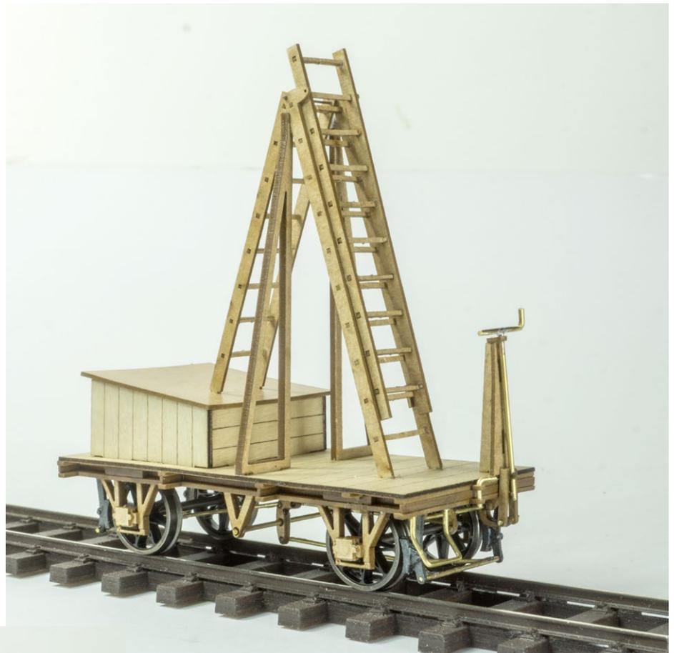
*Die Bilder dieser Seite zeigen den Leiterwagen mit ungefederten Achsen, aber mit Handbremse und 15,5 mm Achsen von Schnellenkamp. Vom Plattformwagen ist in dieser Anleitung kein Bild enthalten – Werkzeugkiste und Leiter muss man sich einfach wegdenken ;-)*
