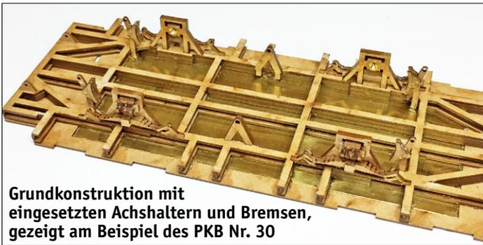
**Grundkonstruktion mit eingesetzten Achshaltern und Bremsen, gezeigt am Beispiel des PKB Nr. 30**
