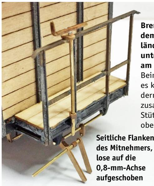
Seitliche Flanken des Mitnehmers, lose auf die 0,8-mm-Achse aufgeschoben
