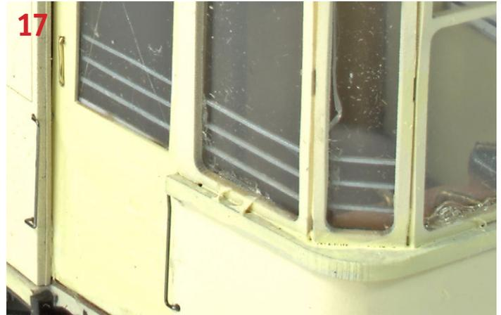
Der zweite, winklige Knick geschieht bei mir mit einer Spitzzange; erst danach erfolgt das Ablängen der Bügel auf ca. 2 mm Länge.
