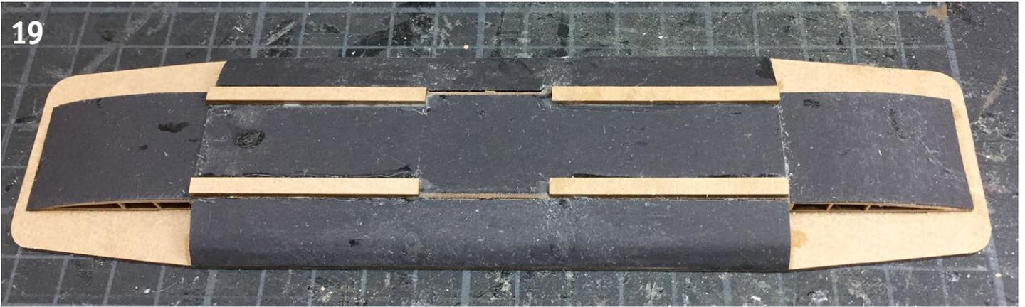
Beim **Kleben der Dachkonstruktion** gibt es allerdings eine **Tücke**: Die Basisplatte neigt trotz ihrer Materialstärke von 1,5 mm dazu, sich bei den Verklebungen an den äußeren Enden hochzuwölben; das ist später kaum korrigierbar. Deshalb ist ganz wichtig: während aller Klebevorgänge am Dachaufbau (auch später beim Aufbringen der Dachhaut) die Basisplatte mit Montageklammern fixieren; ich nehme dafür ein 2x2 cm Vierkanthrohr.
