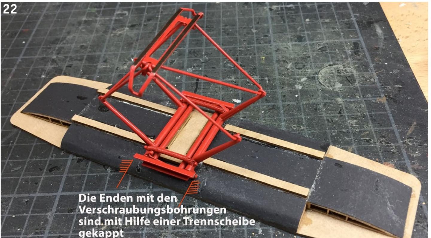
Die Enden mit den Verschraubungsbohrungen sind mit Hilfe einer Trennscheibe gekappt
