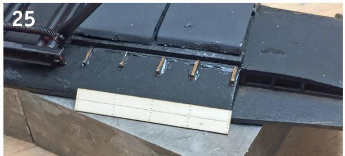
Beim Kleben der Widerstandskästen beginnt man mit den beiden äußeren Kästen, die mit der Vorder- bzw. Hinterkante des Dachaufbaus fluchten, die beiden inneren Kästen werden mit einem Abstand der Dachkanten von 1 mm zu den äußeren Kästen verklebt.
