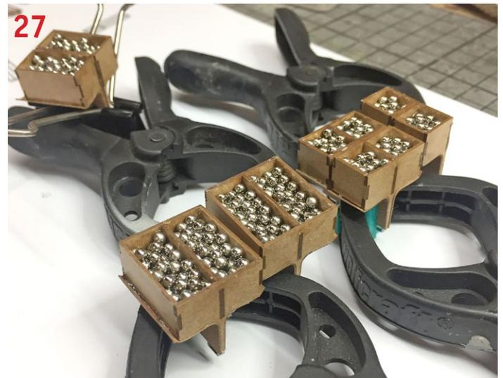
kopfüber mit kleinen Leimklammern (26/27), fülle die Hohlräume und lasse UHU-hart oder Leim darüberlaufen, um die Kugeln zu fixieren. Dann geduldig warten, bis der Klebstoff abgedunsten hat. Ich klebe außerdem noch ein Stückchen Papier von unten auf; zum einen ist das eine Kontrolle, ob keine Kugel über die Kanten übersteht, zum anderen kam es immer wieder vor, dass einzelne Kugel nicht vernünftig klebten und beim Umdrehen das Weite suchten.
