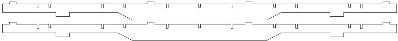
**1. Zwei Längsträger (innen) und vier Drehgestellagerplatten**
