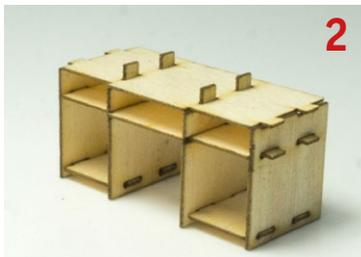
Holzleim). Anschließend werden die überstehenden Laschen mit einem Elektronikseitenschneider abgekniffen und sauber beigeschliffen. Das Resultat sieht dann aus wie auf Bild 3.
